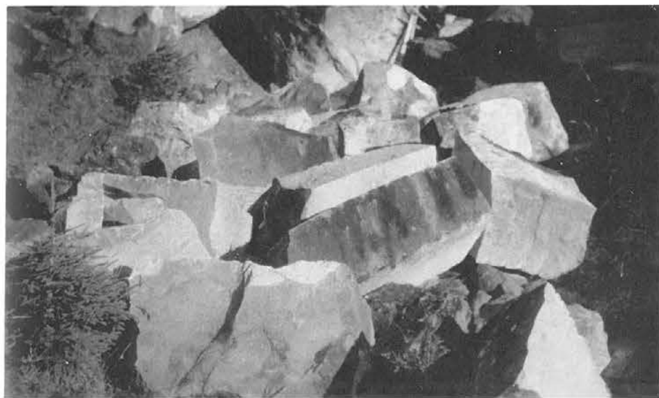
Abb. 48 und 49, Seite 48 Uferschwellen-Mauersteine in rohem Zustande
